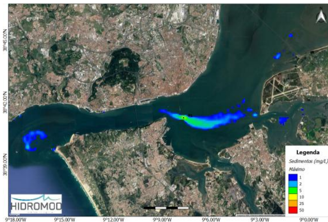
Figura 3. Pluma de sedimentos (máximo) originada pelas dragagens efetuadas no ponto P1
