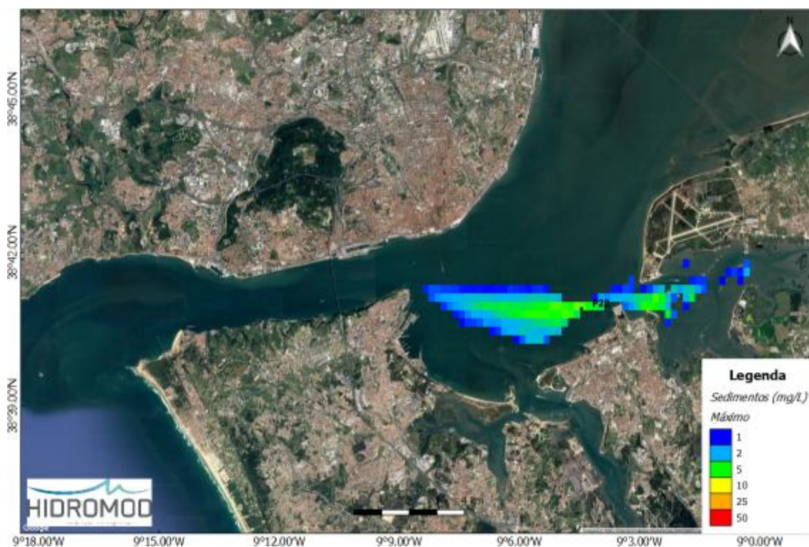
Figura 17. Pluma de sedimentos (máximo) originada pelas dragagens efetuadas no ponto P22
