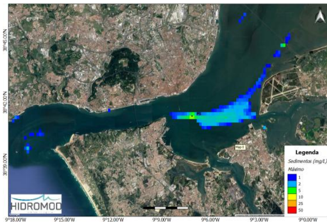
Figura 11. Pluma de sedimentos (máximo) originada pelas dragagens efetuadas no ponto P5
