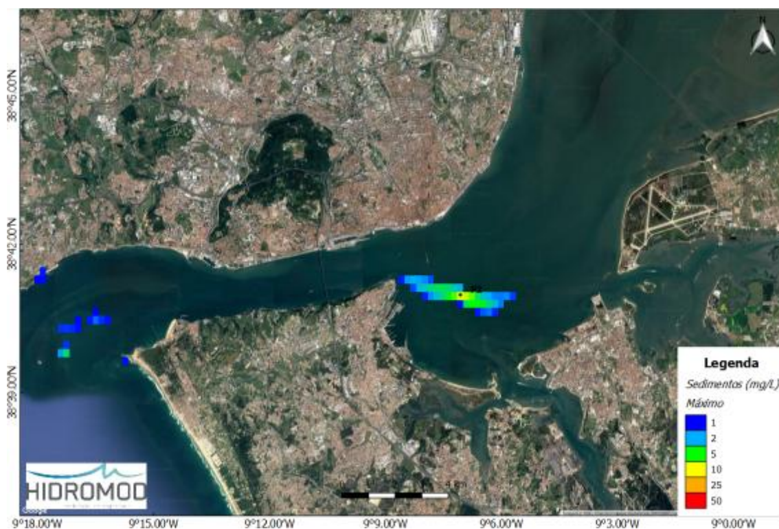
Figura 5. Pluma de sedimentos (máximo) originada pelas dragagens efetuadas no ponto P2
