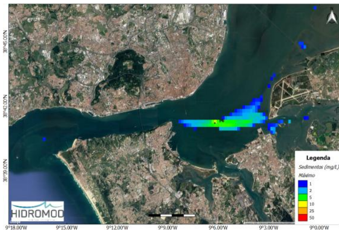
Figura 13. Pluma de sedimentos (máximo) originada pelas dragagens efetuadas no ponto P6
