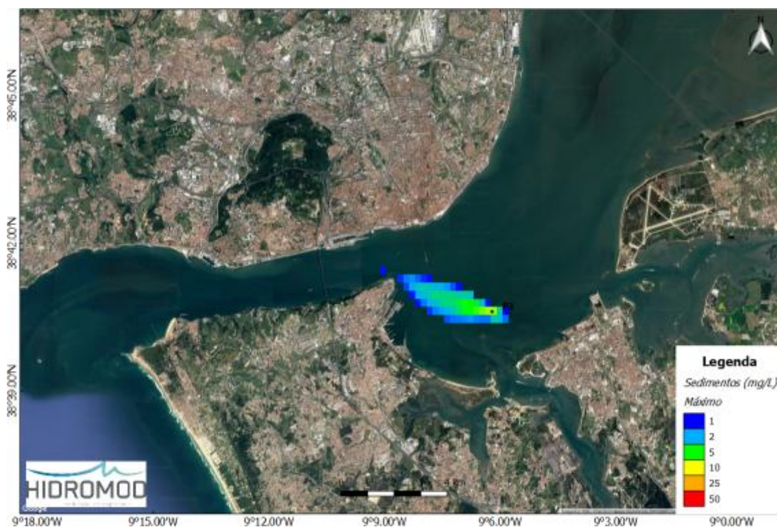
Figura 7. Pluma de sedimentos (máximo) originada pelas dragagens efetuadas no ponto P3
